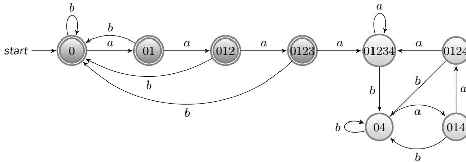
La minimizzazione dell'automa ci fornisce le classi di equivalenza  $\{0\}$ ,  $\{01\}$ ,  $\{012\}$ ,  $\{0123\}$ ,  $\{04, 014, 0124, 01234\}$ , da cui deriva l'automa minimo
