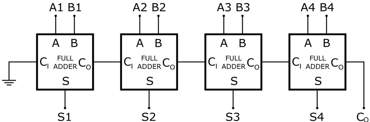
I valori in ingresso sono indicati come le coppie di 4 pin  $A_1, A_2, A_3, A_4$  e  $B_1, B_2, B_3, B_4$ , che rappresentano i bit dal meno al più significativo dei valori A e B. Gli output sono i 4 bit risultanti e marcati con le tag  $S_1, \dots, S_4$ . I riporti, invece sono rappresentati dalle tag  $C_i$  per quello in ingresso e  $C_o$  per quello in uscita.
